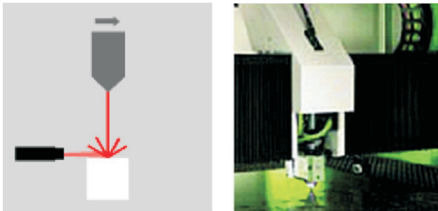
Infrarottemperaturmessung beim Laserschweißen
