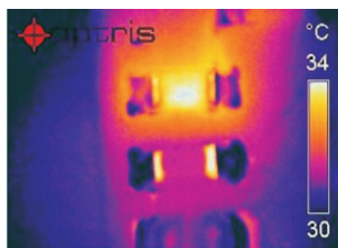
Temperaturmessung an einem Schaltkreis mit Hilfe der Maximalwertfunktion
