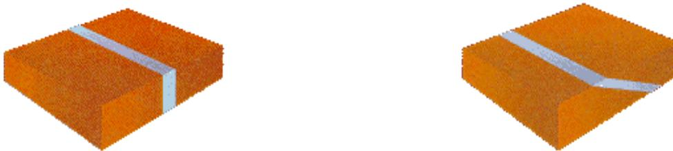
Weitere Möglichkeiten sind: die abgestufte Schäftung, die einseitige Lasche oder das sichern der Klebung durch eine zweiseitige Lasche (von links nach rechts).
