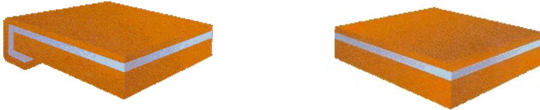
Besonders gefährdet sind relativ schmale Klebeverbindungen, wenn die Schmalseiten von Werkstücken zusammengeführt werden (auf dem linken Bild ist ein stumpfer Stoß abgebildet). Hier kann die Belastbarkeit erhöht werden, indem die Klebefläche vergrößert wird. Auf dem rechten Bild wird die Klebefläche, durch eine schräge Schäftung, um etwa ein Drittel vergrößert.
