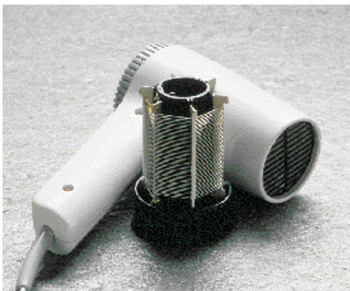
Bild 1. Haarfön beheizt mit einem Runddraht-Element auf Mikanit-Träger
