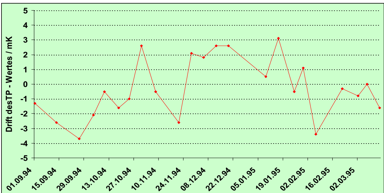
Abbildung 45: Reproduzierbarkeit eines industriellen Präzisionsthermometers bei täglicher Benutzung bis 150°C
