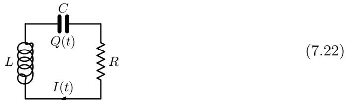
Der Kondensator sei zur Zeit  $t = 0$  auf Ladung  $Q(0) = Q_0$  geladen und es fliesse der Strom  $I(0) = I_0$ . Wie entwickeln sich diese Grössen mit der Zeit?
